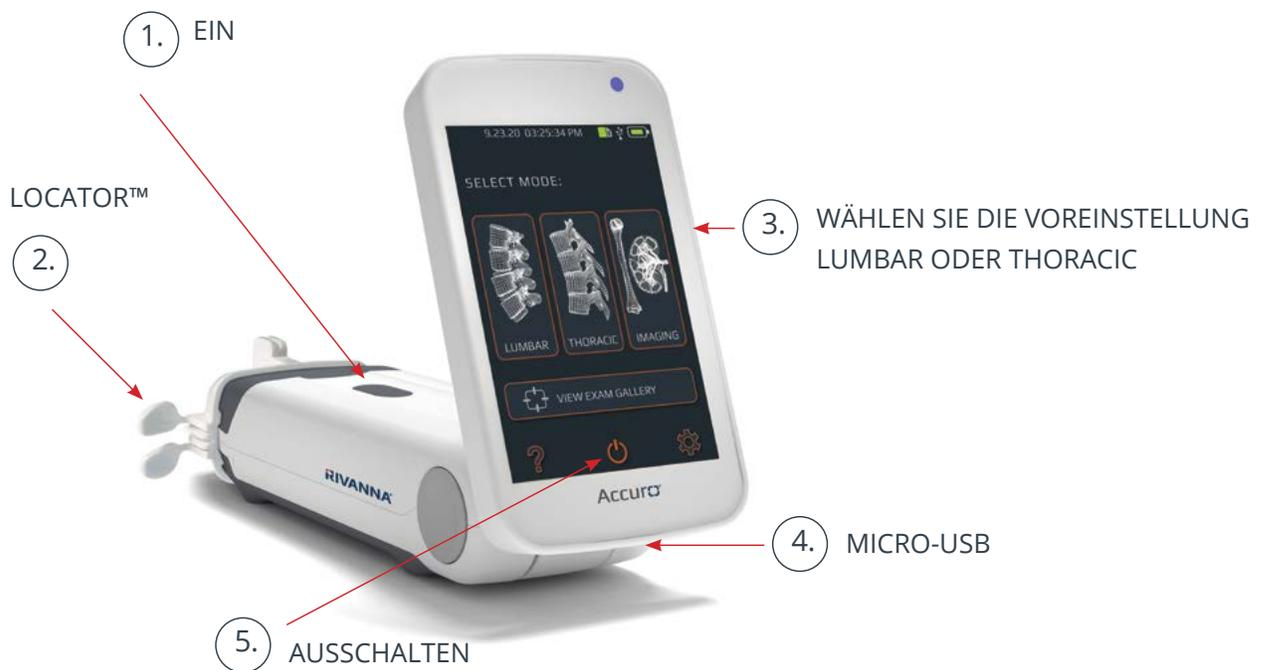
1. Schalten Sie das Accuro ein, indem Sie auf die Taste EIN/AUS drücken.
